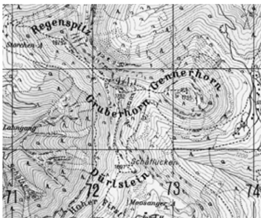
Opravdu kvalitně nakreslená a vytištěná mapa si může dovolit ekvidistanci 20 metrů i v horském terénu. Vrstevnice se ani v nejstrmějších svazích „neslévají“ a jsou všude dobře čitelné.
